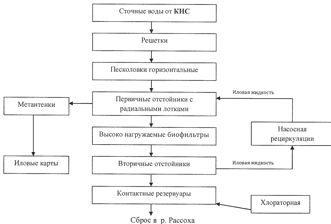
Рис. 1 — Схема работы городских очистных сооружений
